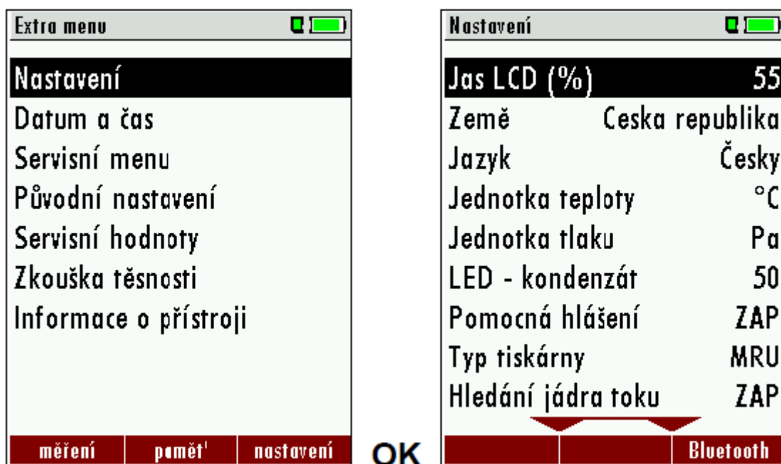
Obrázek 1 Nastavení hodnot pro obsluhu přístroje (Hintz, Erwin. Návod k obsluze, optima 7 [online]. Neckarsulm-Obereisesheim: MRU GmbH, červen 2010 [cit. 10. 7. 2014]. Dostupné z: http://www.mru.cz/pristroje/prenosne-analyzatory/optima-7 )
